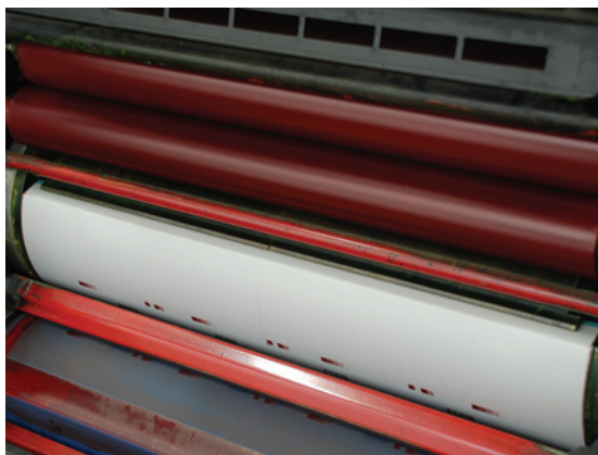
Figura 5 - Impressora offset – Detalhe dos cilindros porta-chapa e entintador de uma máquina de impressão.
